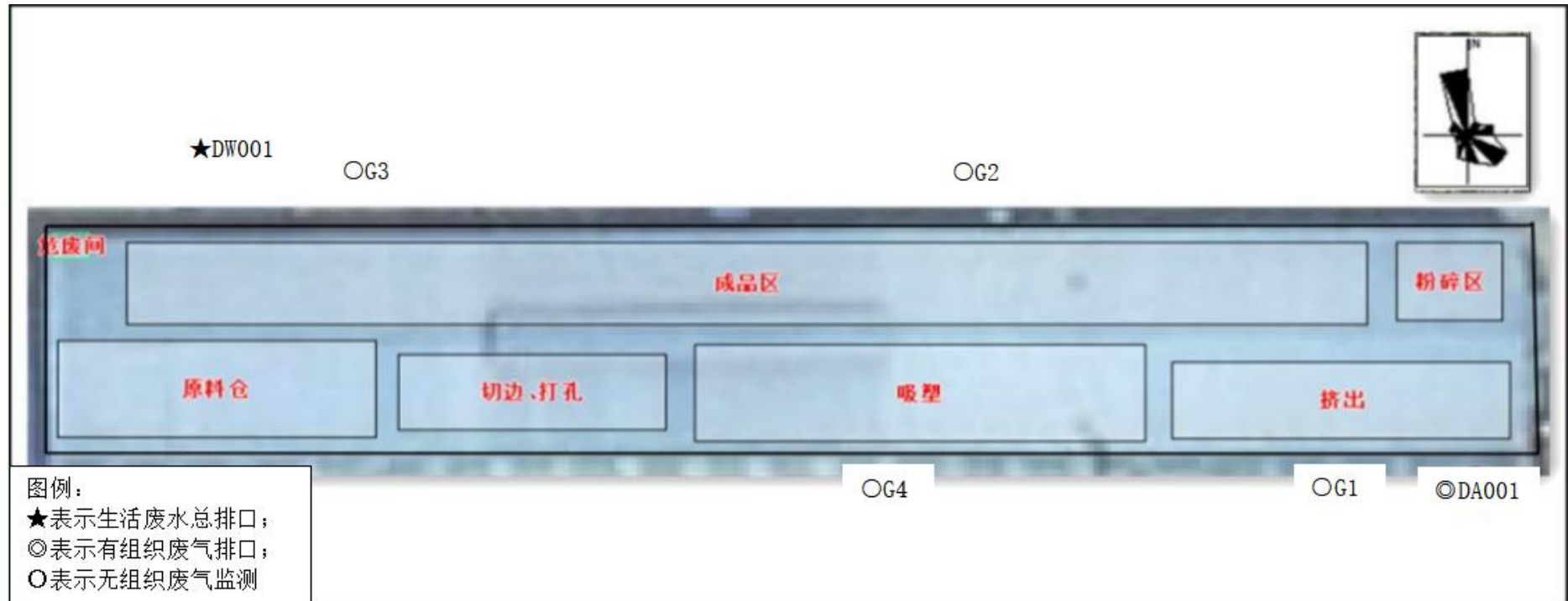
附图 2 湖南正拙新材料有限责任公司平面布置图及检测点位布置图
